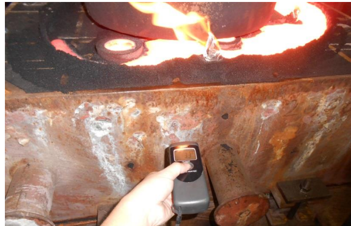
注湯直後の金枠側面温度 33°C
