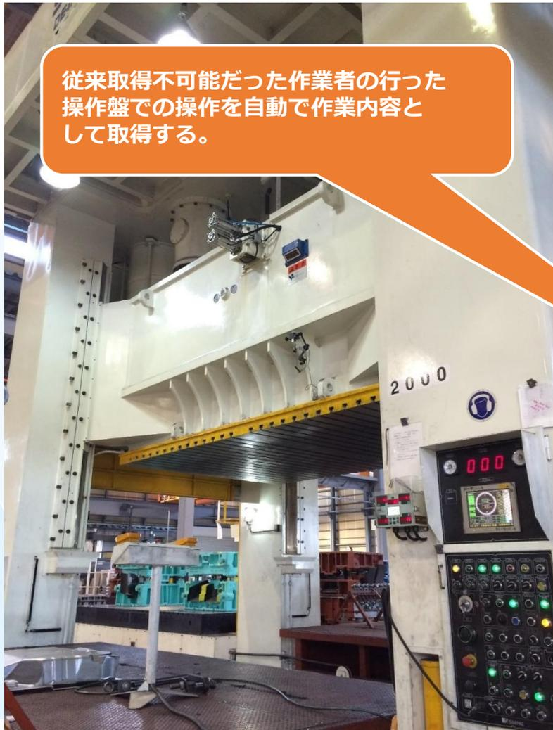
従来取得不可能だった作業者の行った操作盤での操作を自動で作業内容として取得する。
